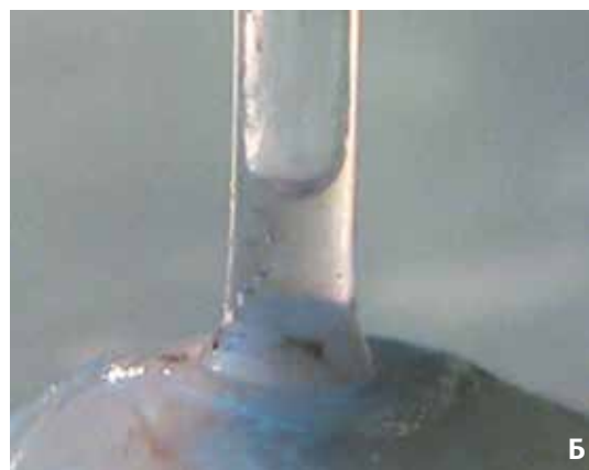
Рис. 2. Измерение гидропроницаемости образцов склеры глаза кролика по высоте столбика жидкости: А — для интактного; Б — для облученного
