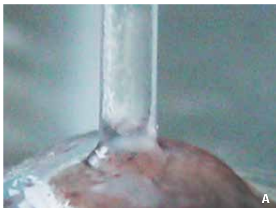
Рис. 2. Измерение гидропроницаемости образцов склеры глаза кролика по высоте столбика жидкости: А — для интактного; Б — для облученного
